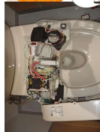
②機械から出ている電源コードが、途中断線していることに気づいた。コードがコンセントに繋がったまま、ニッパーで切り感電した。
